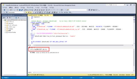
「コマンドは、正常に完了しました」。と表示されている事を確認します 上記でデータベースが作成されています。
