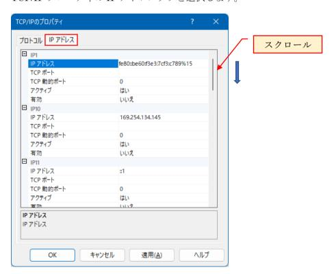
TCP/IP プロパティの IP アドレスタブにある IPALL の TCP ポートに **1433** を指定します。
